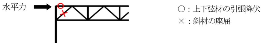
【トラス形式構造物は日本建築学会「鋼構造限界状態設計指針・同解説」により、原則構造区分 S-III ( $D_s=0.45$ ) 告示  $D_s=0.4$  として弾性解析により設計するが、トラス梁ラーメン架構のトラス梁は線材置換でもよい。】
