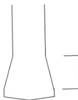
傾斜部の摩擦は押し込み側の耐力には加算できない
