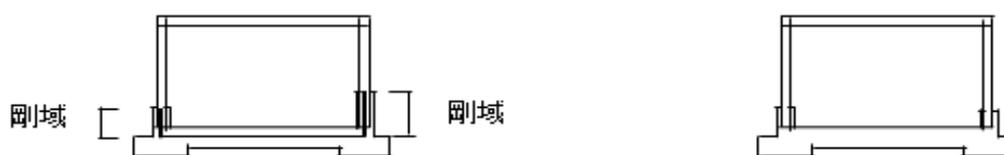
【一般的な根巻き柱脚は、柱脚固定としたモデルでよい。】
