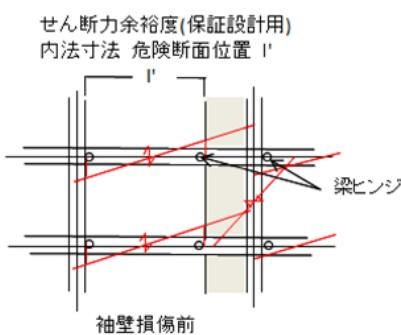
袖壁が損傷した時の危険断面位置( $M_u$ 算定位置)は端部寄りとなるが、位置は明らかでないので柱面を危険断面位置とした保有水平耐力。
