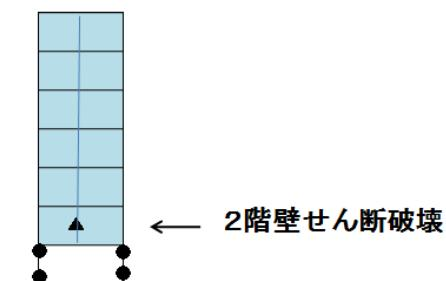
【上部は  $D_s=0.55$  1階は FA であれば  $D_s=0.3$  となるが、1階にエネルギーが集中することになり、エネルギー吸収の観点から 1階の強度を確保し、 $D_s=0.55$  同等の強度抵抗型とする必要があります。】
