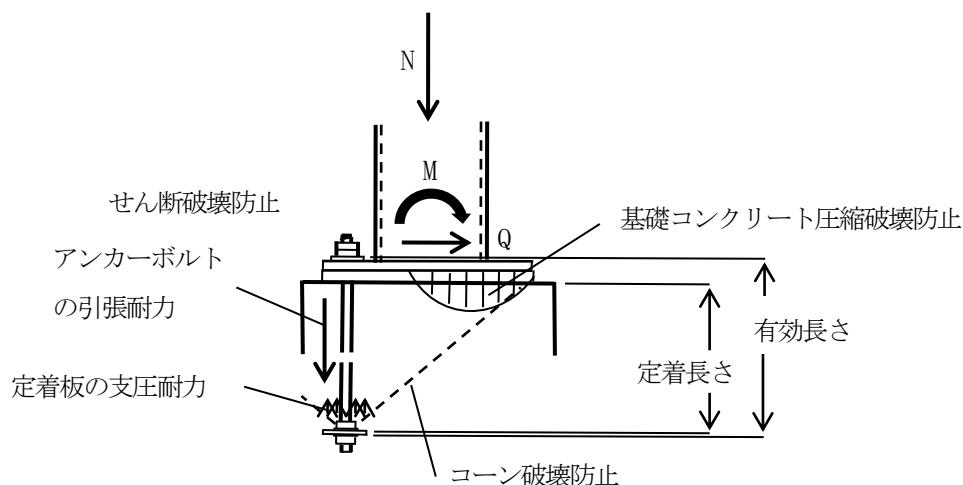
【露出型柱脚部の設計において、ルート 1-1, ルート 1-2 は保有耐力接合又は破壊しないよう十分な強度とするか十分な韌性の確保が必要となります。 $(C_0=0.3, \text{ルート } 1-2 \text{ 割り増し率 } \gamma=1.67)$
