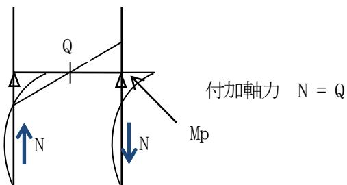
**2.7 基礎梁増し打ちコンクリートによる 1 階柱の可撓長さを考慮して検討してください。**
