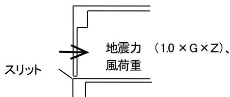
【十分な触れ止め鉄筋等で本体建物と振動性状が同じと見なせる場合は、 $A_i$  分布による地震力に対しての検討でよい。】
