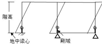
S造の基礎梁の取りつかない基礎は、柱脚の応力を基礎心まで曲げ戻し、保有水平耐力時点でも柱脚より下の部材が先行して塑性化することで基礎部分が塑性回転しないことの確認が必要です。
