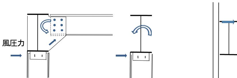
【折版屋根の縦洞縁や間柱からの風荷重を受ける大梁の弱軸曲げについて、長期の応力と組み合わせで検討を行う必要があります。】
