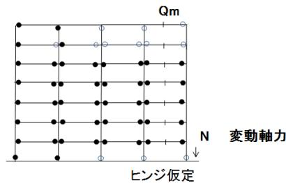
【連層耐震壁が特定層で部分崩壊となる場合の  $Q_{un}$  分布が適用できる事例】
