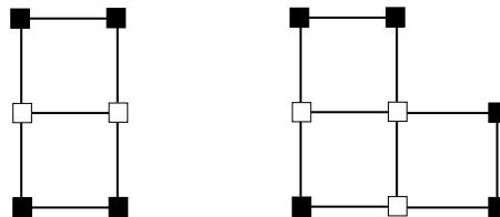
また、上層階が 4 本柱となる建築物においても、45 度方向の検討、または当該階の一次設計用地震層せん断力係数を 1.25 倍 ( $C_0=0.25$  以上) による応力割り増しの検討を行い、直下階まで応力を配分して検討してください。
