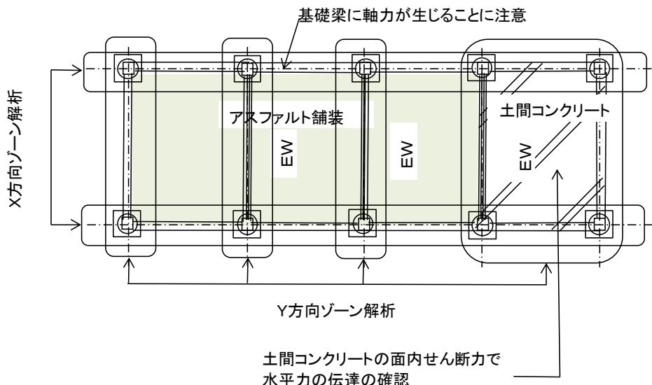
【剛床仮定が成り立たない場合は、各杭に作用する軸力に応じて杭頭の変形が同一変位になるフレームごとに杭の水平力の検討を行う必要があります。】
