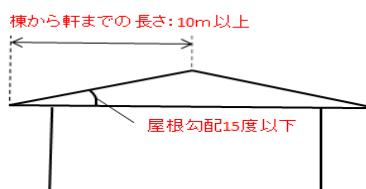
$$\text{割り増し係数} = 0.7 + \sqrt{\frac{\text{屋根勾配と棟から軒先までの長さに応じた値}}{\text{屋根形状係数} \times \text{垂直積雪量} (\text{単位m})}}$$
