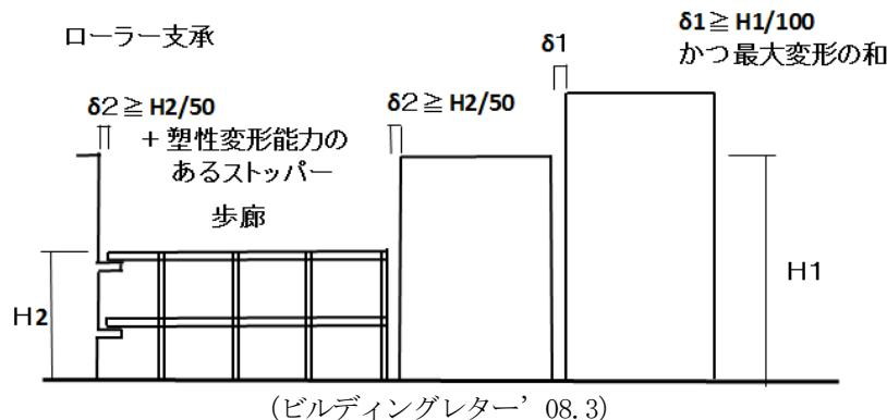
①構造的に分離した別棟がある場合は、相互の間隔の確保は許容応力度計算の水平力に対して建築物の衝突がない間隔が必要です。
