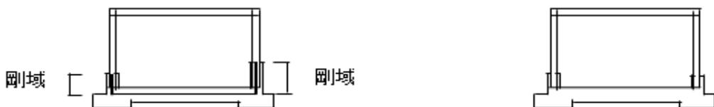
【一般的な根巻柱脚は、柱脚固定としたモデルでよい。】
