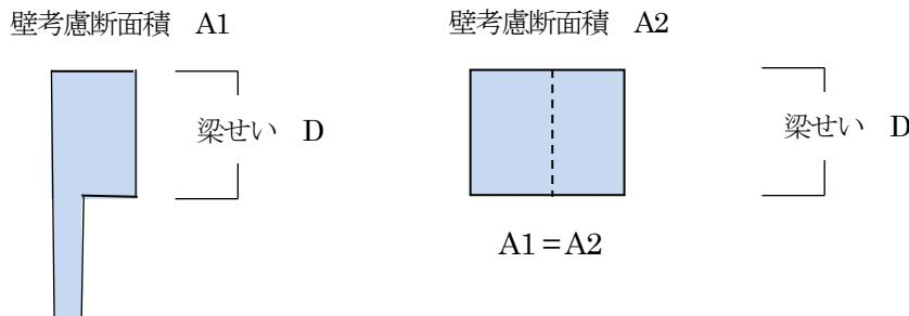
【壁の両側の柱際にスリットを小窓口で入力すると、構造計算ソフト上の設定によっては包絡窓口として取り扱われます。その場合は壁の剛性や重量が正しく評価されないことがあります。
