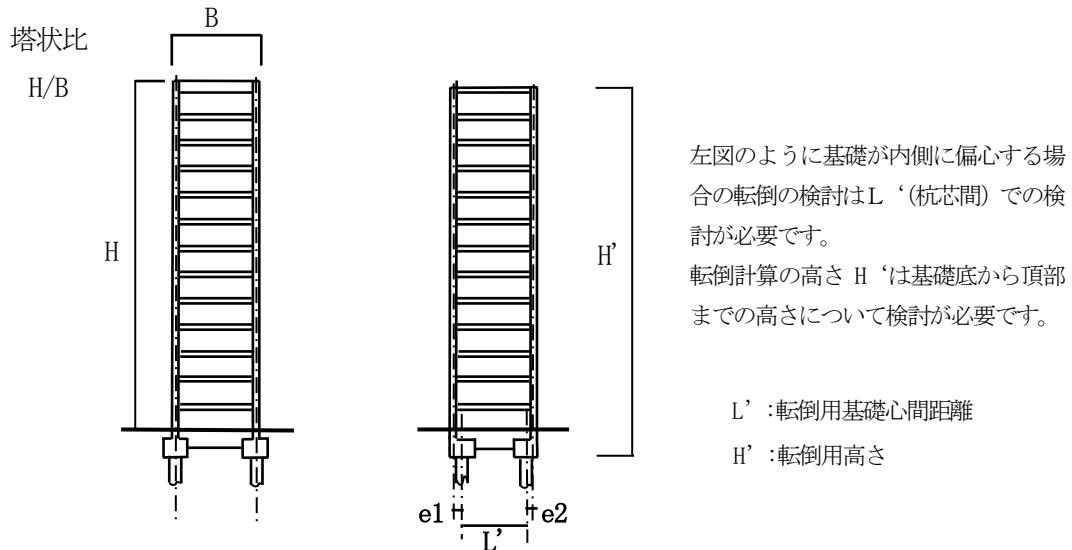
幅  $B$  は建物の重心位置の柱の外側とし、塔状比が 4 を超える建物は転倒の検討を行ってください。
