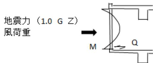
2.32 一方向階段のプレース効果による地震時水平力負担について説明してください。
