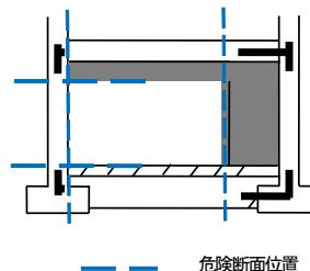
2.28 共同住宅等の張間方向が耐力壁フレーム、桁行フレームがラーメンフレームの建物で2階以上の階の耐力壁がせん断破壊し、2階以上は  $D_s=0.55$  としていますが、1階の  $D_s$  は崩壊形が未形成ですが  $D_s=0.45$  となっています。1階の崩壊形を確認し  $D_s$  を定めるか最大の  $D_s=0.55$  以上として検討してください。
