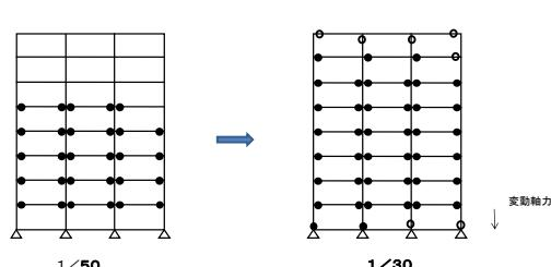
2.23 連層耐震壁が曲げ崩壊形となっていますが、未崩壊の妻側ラーメン架構の崩壊形を確認してください。
