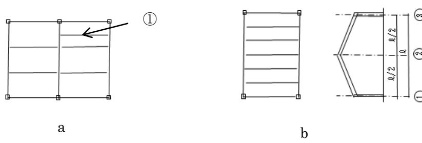
横補剛間隔、補剛材の剛性、耐力を満足する梁は保有耐力横補剛されているとして、梁の曲げ耐力は全塑性モーメント ( $M_p$ ) とすることができます。また、横座屈耐力  $M_{cr}$  の考慮の有無は設計者判断とすることができます。
