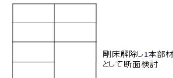
**1.9 柱脚ピンモデルとしていますが、アンカーボルトの剛性による影響について検討してください。**
