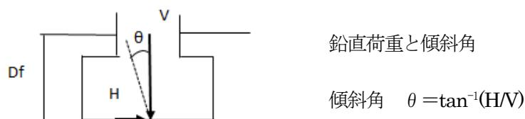
【告示（平13国交告第1113号第2）の表（1）項による支持力を用いる場合は水平荷重時に基礎に作用する鉛直方向に対する短期許容力度は長期の2倍ではなく、水平荷重による鉛直方向に作用する傾斜角による低減が必要になります。直接基礎で剛床仮定が成立する独立基礎では、基礎に作用する短期地震時水平力Hを短期基礎軸力Vで除したH/Vとして求めた傾斜角により支持力係数の補正を行います。地盤改良（柱状改良）については基礎底で改良地盤に作用する荷重の傾斜角は0としてよい。】
