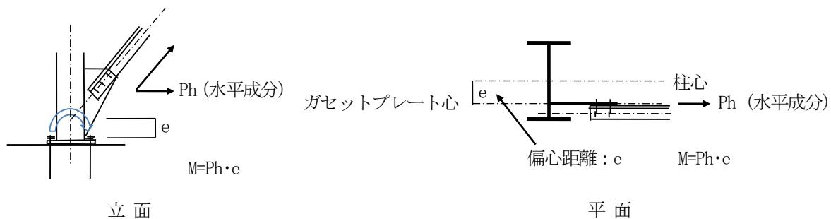
**1.18 伸び能力のあるアンカーボルトを使用していますが、アンカーボルトの有効断面積、保有耐力接合について説明してください。(H19 国交告第 594 号第 1, 第 2, 第 4)**
