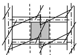
【剛接型 骨組みの剛性、応力、変形、強度等について適切なモデル化及び断面設計を行う必要があります。】
