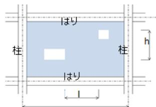
$I \geq 1.5h$  かつ  $I \geq 1.0\text{m}$  のとき、面積等価の開口部とみなす
