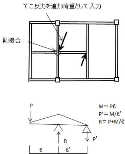
1.29 一方向階段のプレース効果による地震時水平力の負担について説明してください。
